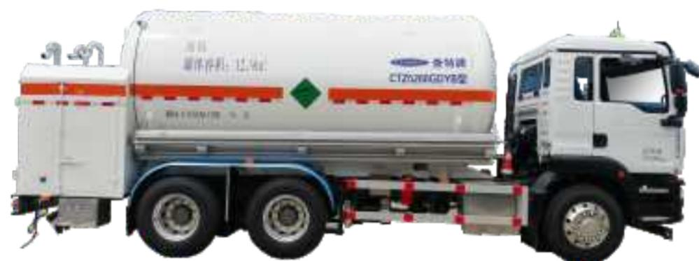
深冷液体带泵运输车（又称ORCA）用于液氧、液氮、液氩等各种深冷液体以及液态二氧化碳的运输，并做到对中小型深冷液体储罐液体充装的精准计量。
