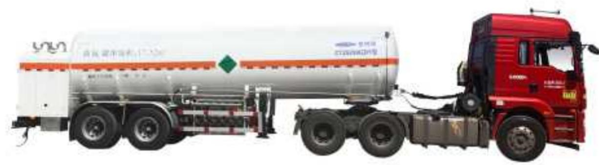
深冷液体运输半挂车用于液氧、液氮、液氩等各种深冷液体以及液态二氧化碳的运输，产品按照国内相关规范要求与设计制作。
