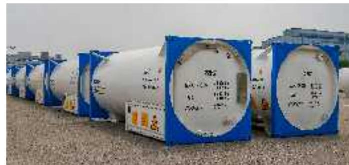
冷冻液化气体罐式集装箱 (UN T75)
