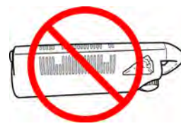
Placing Flat on Face or Edge
