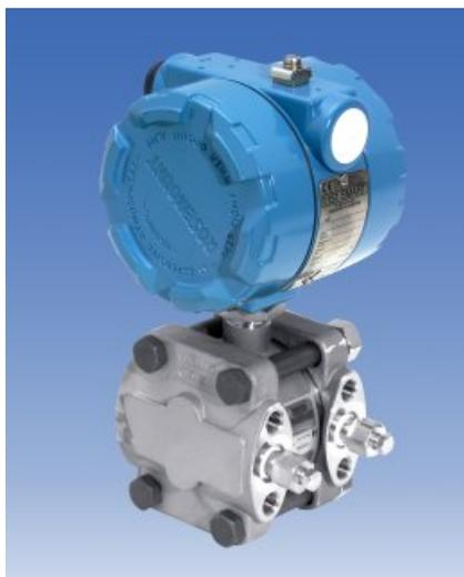
Zum Messen des Differenzdrucks wird der bewährte ROSEMOUNT 1151 DP5 SMART an die Messstrecke angeschlossen. Der Transmitter erzeugt ein 4 ... 20 mA Ausgangssignal, aus welchem die Elektronik den momentanen Durchfluss berechnet.
