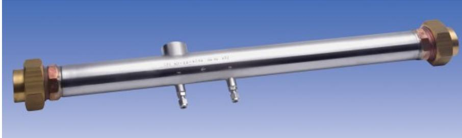
Die Durchflussmessstrecke bildet den Kern des Systems. Sie arbeitet nach dem Prinzip der Wirkdruckmessung, d.h. der Durchfluss wird mit Hilfe des Druckabfalls an einer Querschnittsverengung berechnet. Die Messstrecke hat keine beweglichen Teile und ist somit völlig wartungsfrei. Der Einbau in das Rohrleitungssystem kann durch Einschweißen, mit Flanschen oder mit Messingverschraubungen (s. Abb.) durchgeführt werden.
