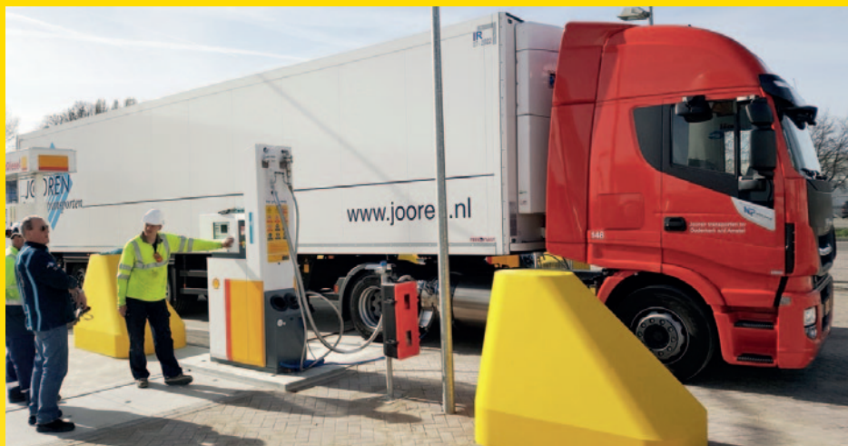
Ukázka plnění LNG nákladního automobilu
