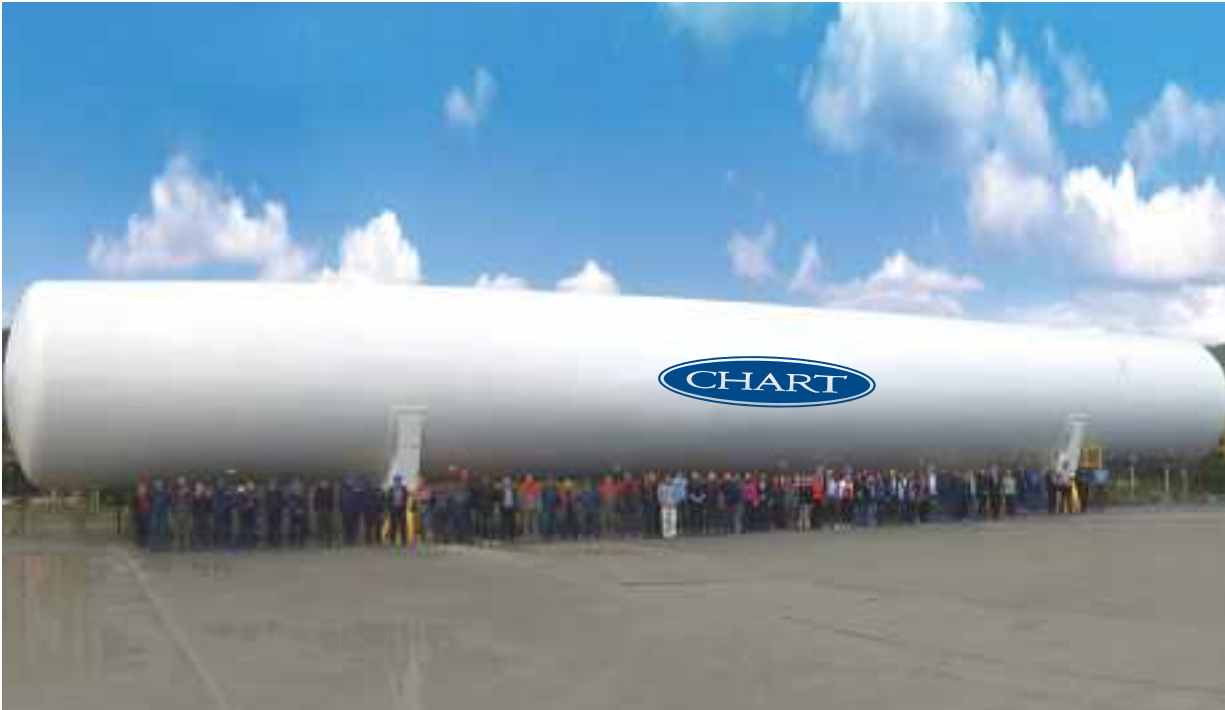
为挪威项目建造1000m³大型储罐（捷克工厂制造）
